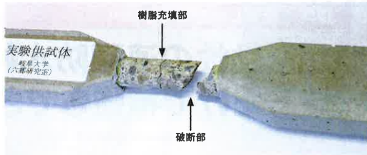
写真3 ■ ひび割れに樹脂を注入した供試体で引っ張り試験を実施した結果。ひび割れ部分ではなく、コンクリートの母材で破断した(写真:本誌)
